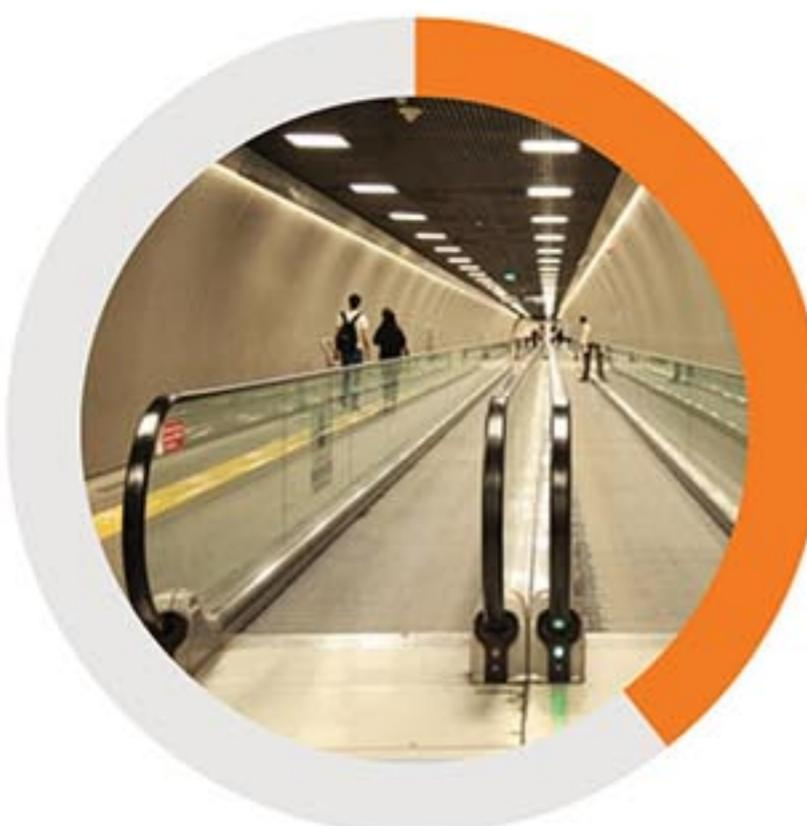
Yürüyen merdivenlere benzer bir yapıya sahip olan yürüyen bantlar, düz bir platform yolun hareketli hale getirmesiyle ağırlıklı olarak düşük eğimli mekanlarda insan ve hafif eşya taşımacılığında kullanılır. 1.000 mm'ye kadar yol genişliğine sahip olabilirler ve insan trafiğinin yoğun olduğu metro ve tren istasyonları, havaalanları, alışveriş merkezleri gibi mekanlarda tercih edilirler.
