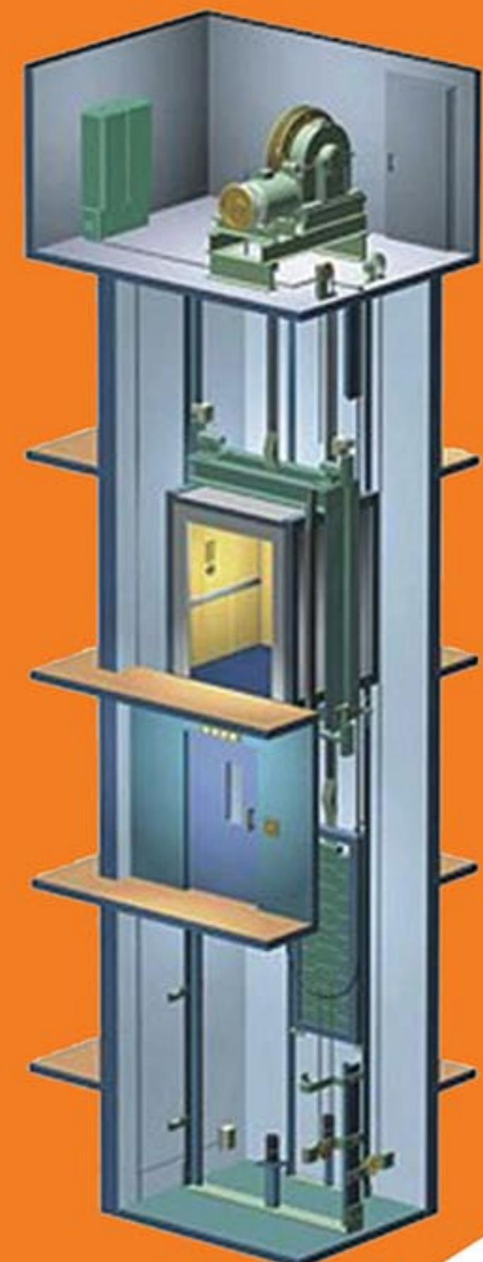
Makine daireli asansörler ülkemizde ve dünyada en sık kullanılan sistemlerdir. Çalışma prensipleri temek olarak bir makine - motor mekanizmasının makara ve halatlar aracılığıyla asansör kabinine hareket gücü verilmesi prensipine dayanır.
